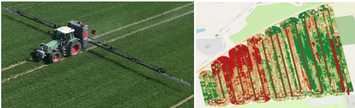
Im Projekt digiMan entwickeltes Schlepper-Sensorsystem (links), mit dem System erstellte Ertragspotenzialkarte (rechts)
