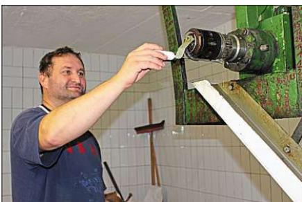
**Seit mehr als 30 Jahren** wird auf dem Hof der Familie Kraller in Wies bei Tittmoring mit der Schneckenpresse Sonnenblumenöl in Bio-Qualität gepresst. Hier prüft Johann Kraller gerade die Temperatur.
