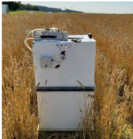
Lachgasmessung mit der Closed-Chamber-Methode in einem Klee grasbestand (links) und in einem Weizenbestand mit Haubenverlängerung (rechts)
