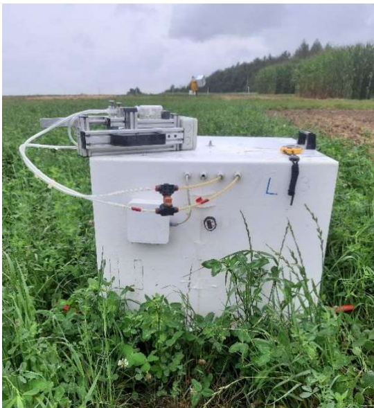
Lachgasmessung mit der Closed-Chamber-Methode in einem Klee grasbestand (links) und in einem Weizenbestand mit Haubenverlängerung (rechts)
