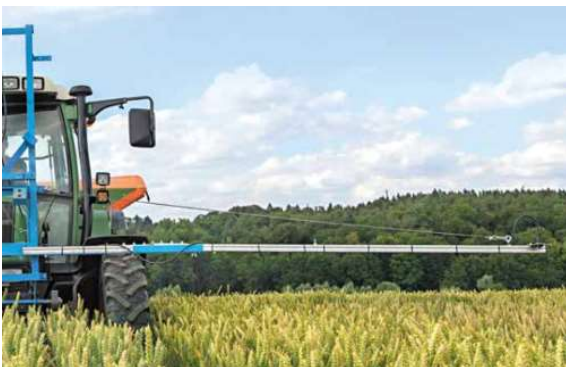
Einsatz eines multispektralen Sensors in Winterweizen (links) und Versuch zur sensorgestützten teilflächenspezifischen Düngung, Projekt digisens
