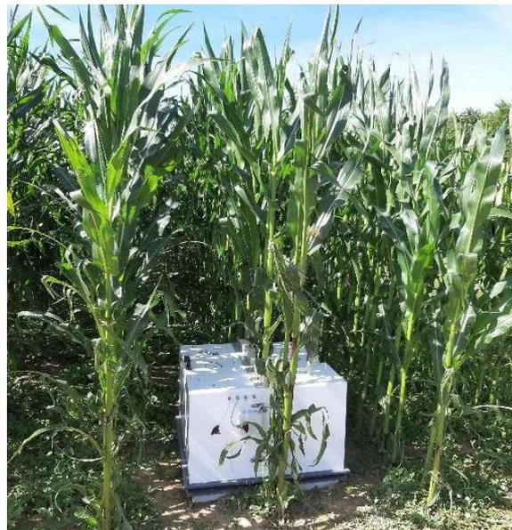
*Lachgasmessung mit der Closed-Chamber-Methode in einem Kleeerbestand (links) und in Mais mit geteilter Haube (rechts)*
