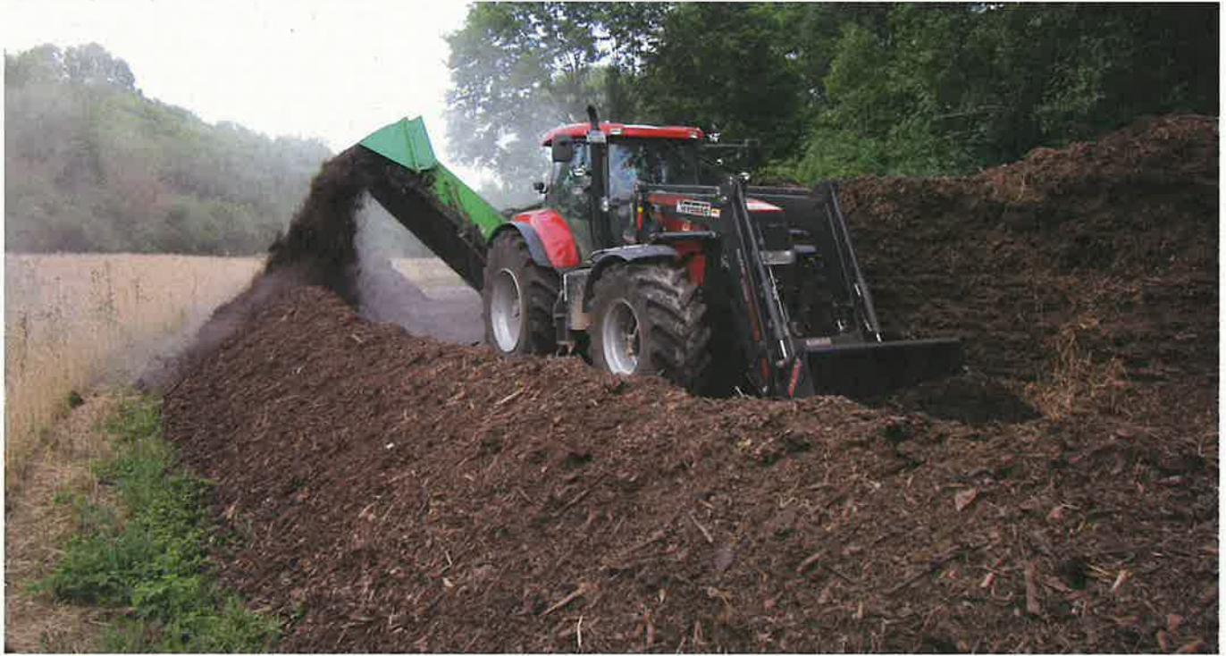
Mit einer Kompostwendemaschine kann der aerobe Kompostierungsprozess der Bakterien, Pilze, Würmer usw. unterstützt werden. Quelle: Werner Vogt-Kaute
