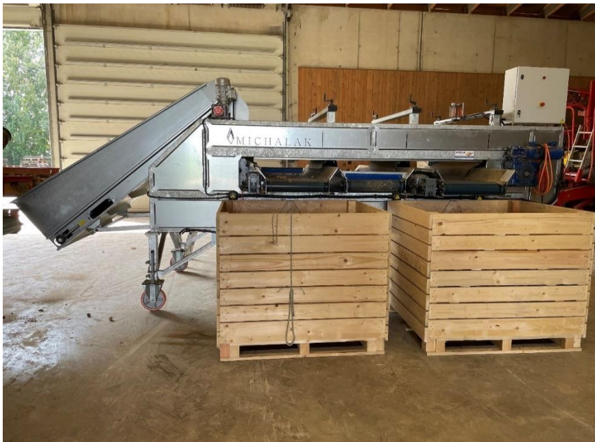
Rollensortierer in der Kartoffellagerhalle
